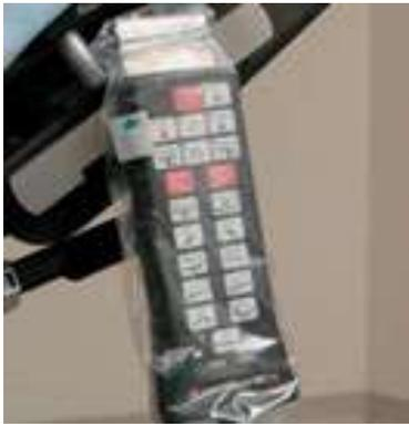
Рис. 11 а,б Покрытия для пультов управления
